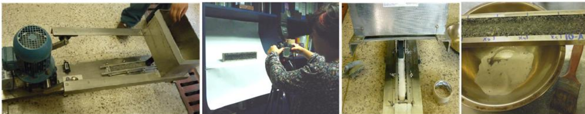
Figura 4: Procedimiento del ensayo de medición del exceso de asfalto
