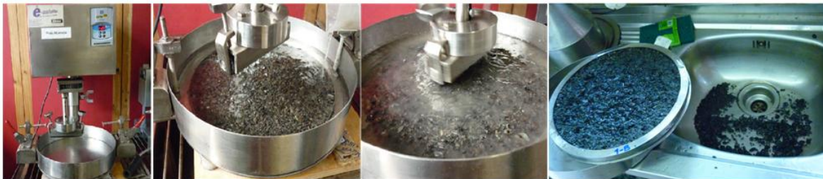
Figura 3: Procedimiento del ensayo de medición de la pérdida de agregado
